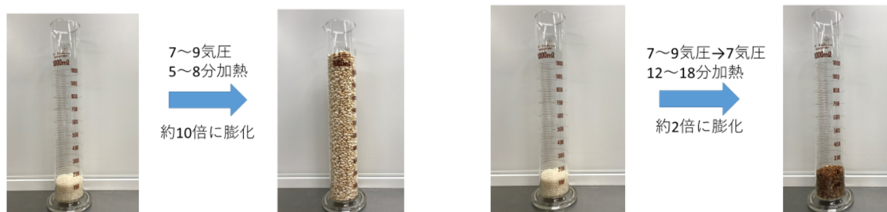
図 1 穀類膨化機の圧力と加熱時間の違いによる膨化程度の差異
